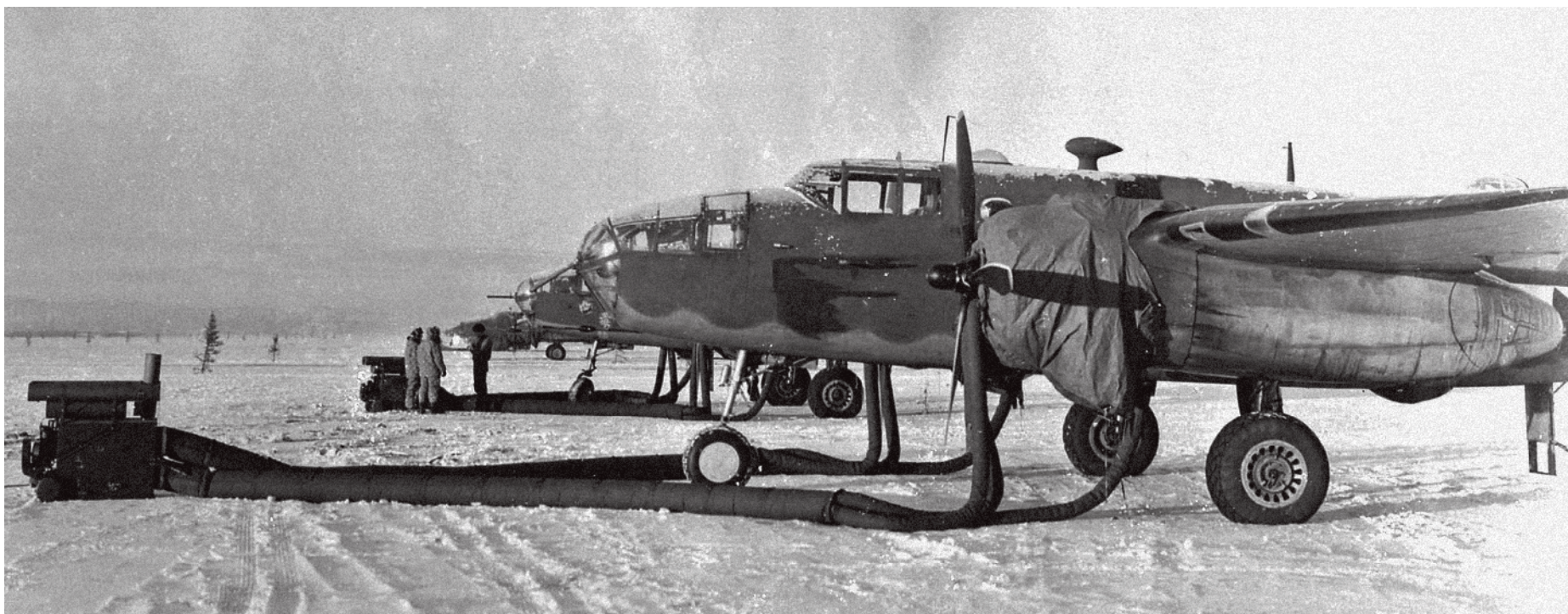
Подогрев моторов самолётов B-25 B-25 aircraft engines preheating
