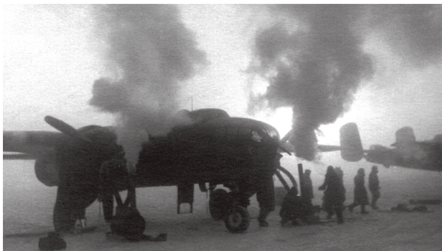
Подогрев моторов самолёта B-25 Heating the engines of B-25 aircraft
